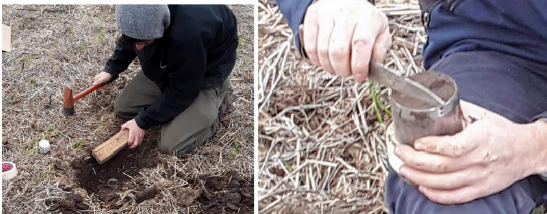
Figura 6. Extracción de muestras de densidad aparente (DAP/BDS) con cilindros de volumen conocido (3 muestras por estación por profundidad),
