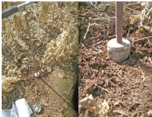
Figura 4. Extracción de muestras para COS y densidad aparente (DAP/BDS) en una misma muestra, utilizando un barreno de \pm 4\text{ cm} de diámetro.
